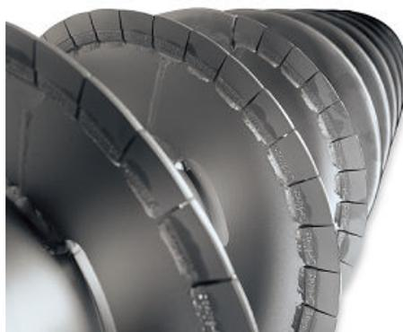
Ejemplo de las plaquitas de carburo de tungsteno instaladas en un decanter centrífugo Sigma
