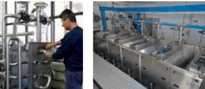
Calentadores Rápidos para extracción a baja temperatura (izquierda) y batidoras circulares con ahorro de energía Atmósfera (derecha)
